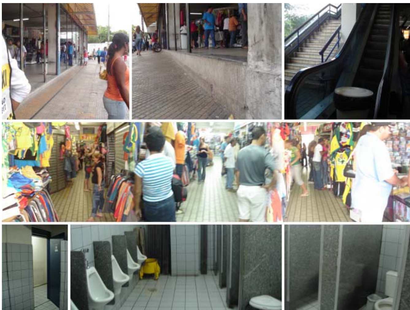
Falta tudo no que diz respeito à acessibilidade; não há estacionamento para P.N.E., rotas de acesso, rampas, elevadores, banheiros adaptados, espaço de circulação ou qualquer outro item que possibilite conforto a P.C.R.
